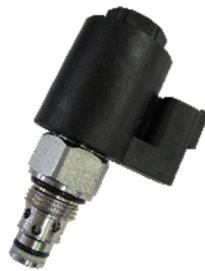
2/2 Wegesitzventil stromlos geöffnet max. 350 bar max. 40 l/min
