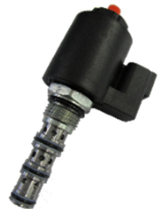
4/2 Wegeschieber max. 210 bar max. 10 l/min
