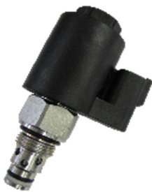
2/2 Wegesitzventil stromlos geschlossen max. 350 bar max. 40 l/min
